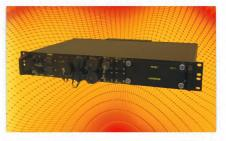
Der 19-Zoll-PC entspricht der Schutzart IP65
